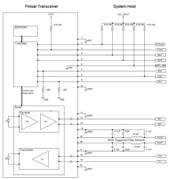
**Figure 4-Host-Module Interface**
